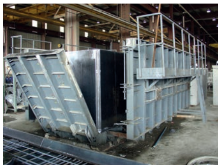
图 5, 6 和 7: Toyotaforms 丰田模具提供的模具, 无需移除内芯任何部件便可完成脱模
